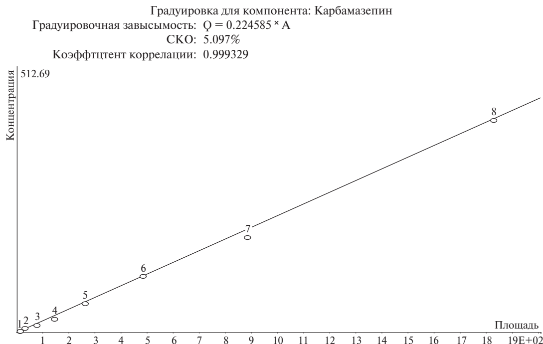
Рис. 3. Калибровочная кривая зависимости концентрации карбамазепина от площади хроматографических пиков
